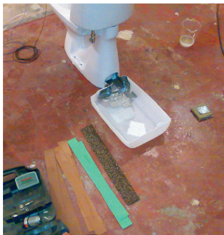
Figur 1: Kontrollmätningar av stomljud från WC stol i laboratorium under arbetet med handboken.
