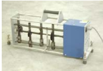
Figur 4. Hammarapparat från Norsonic för simulering av stegljud på bjälklag
