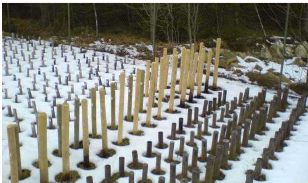
Figur 1. SPs försöksfält i Borås (februari 2007) med provning av stängselstolpar. Figure 1. SP's test site in Borås (February 2007) with fence post trial.
