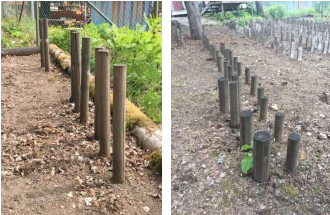
Figur 2. Efter inspektionen i juni 2016 fanns endast tryckimpregnerat material, NTR klass A, kvar i försöket.
