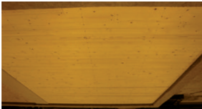
Exponerad träbeklädnad före brandprov
