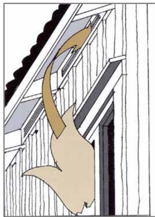
Risk för brandspridning till takfot och vind. BBR 19 har infört hårdare krav än tidigare.
