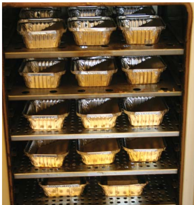
Laboratoriprovning av fuktkänslighet (enligt NT Build 504) hos brandskyddat trä för bruksklass INT.
