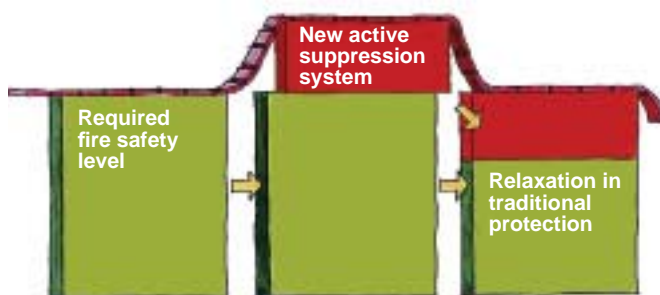
Sprinklerite kasutamise põhimõtte tuleohutuse projekteerimisel: sprinklerite paigaldamisega saavutatud suurem tuleohutus võib vähendada passiivsete tulekaitsevahendite kasutamist, tagades endiselt samasuguse või kõrgema tuleohutuse taseme.
