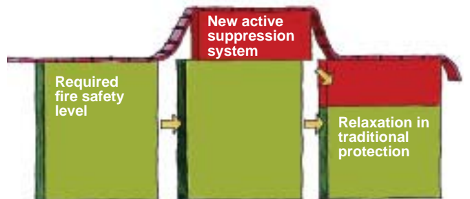
Sprinklereitä hyödyntävän paloturvallisuussuunnitteluun periaate: Paloturvallisuustason noustessa käytettäessä automaattista sammutusjärjestelmää voidaan lieventää passiivisia keinoja ja silti täyttää samat tai päästä korkeampiin turvallisuustasoihin.
