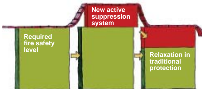
Principe de l'ingénierie de la sécurité incendie qui inclut les sprinklers:
