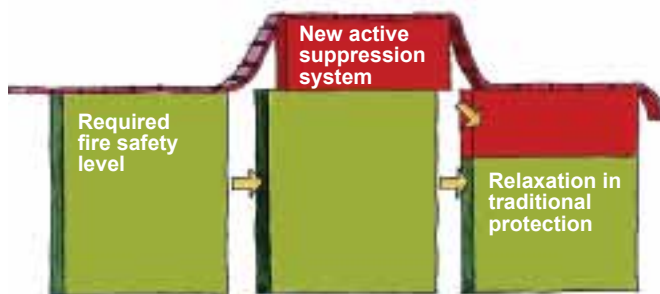
Zásady pre navrhovanie požiarnej bezpečnosti sprinklery: Zvýšená požiaru bezpečnosť inštalácií sprinklerov môže viesť k uvoľneniu pasívnych protipožiarnych prostriedkov a stále spĺňajúce rovnakú alebo vyššiu úroveň bezpečnosti.
