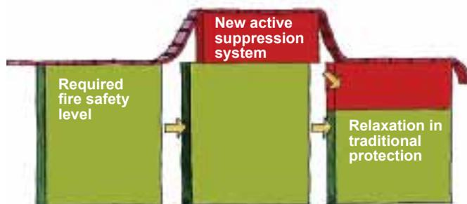
*Principio para el diseño de seguridad contra incendios mediante el uso de rociadores: Aumentar la seguridad contra incendios usando instalaciones de rociadores puede conducir a una flexibilización de los medios de protección pasiva contra incendios, y aún así cumplir con niveles de seguridad iguales o superiores.*
