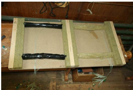
Figur 2. Exempel på provelement för provning av brandstopp i modulkonstruktioner.
