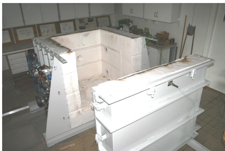
Figur 4. Kubikmetersugn för brandprovning.
