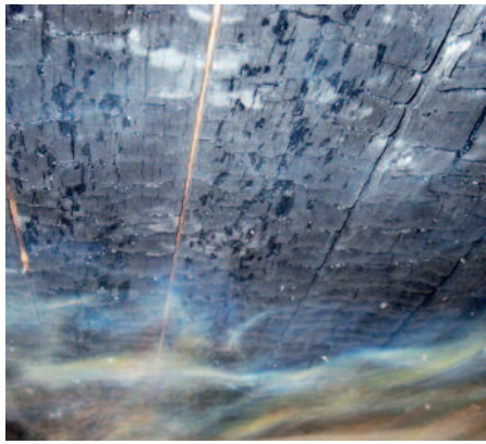
Exponerad och förkolnad träbeklädnad efter brandprov.
