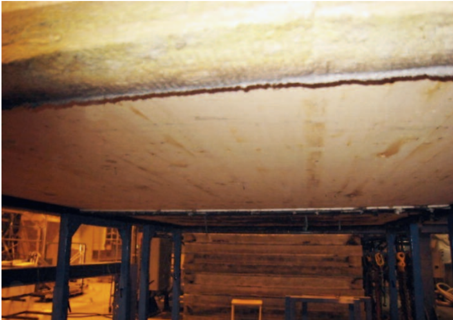
Oförstört underlag (spånskiva) bakom träbeklädnad efter brandprov.
