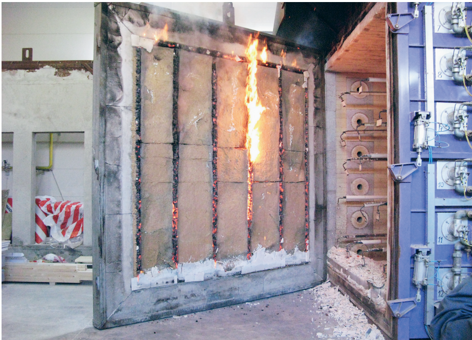
Fullskaligt brandprov av väggelement. Beklädnaden har fallit ned. Isoleringen skyddar träregel från sidan.
