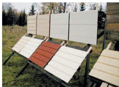
Provning av väderbeständighet för utomhusbruk (Bruksklass EXT). Accelererad åldring överst, naturlig åldring under.
