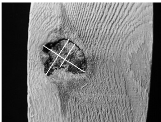
Figur 9. Mätning av kviststorlek i kvistens huvudriktningar. Storaxeln, lillaxeln samt en axel mitt på storaxeln är markerade. Den framräknade kviststorleken varierar i detta fall ca 10%, beroende på mätsätt.
