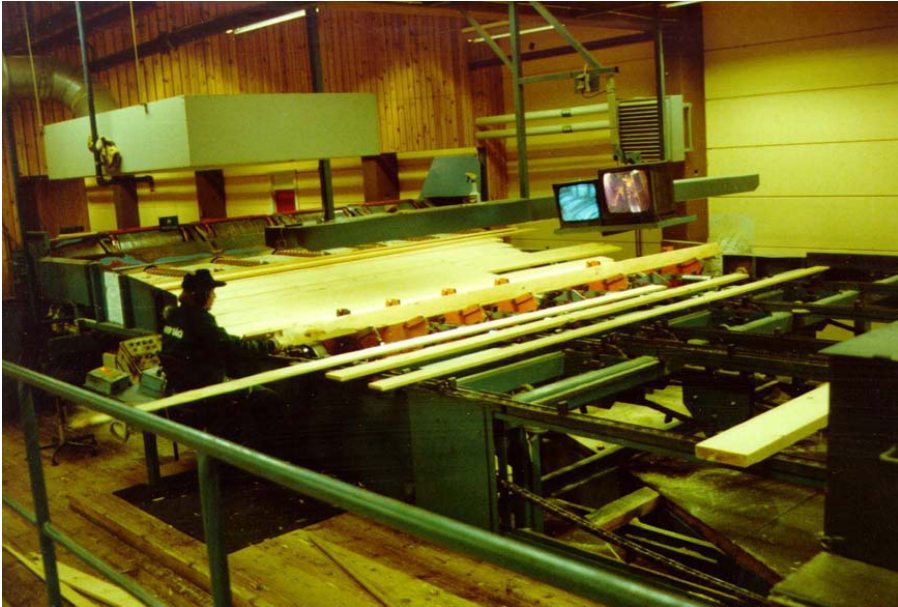
Figur 15. Operatören drar ut virkesstyckena till rätt kapställe.
