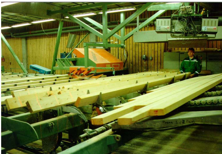
Figur 14. Rotkap. Rotkaparen har hjälp av lasermarkeringar i toppänden (hitåt) för att se var modulgränsen ligger, vilket underlättar kapbeslutet.
