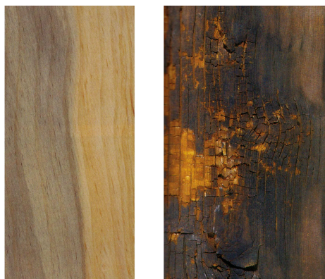
Figur 3.4: Trä angripet av blånadssvamp till vänster och brunröta till höger. Figurer från Hoadley [20]
