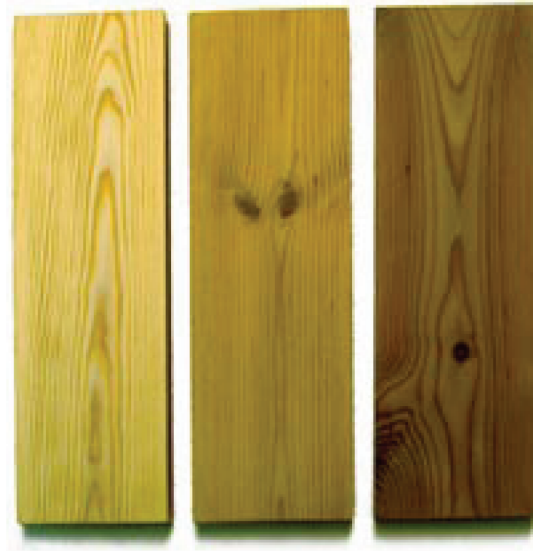
Figur 3.8: Färgförändring av gran behandlad med ThermoWood metoden, från vänster till höger: obehandlad, Thermo-S och Thermo-D. Figur från ThermoWood Brochure www.thermowood.fi
