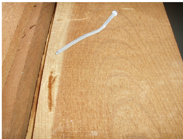
Figur 3.11: Färgförändring på ytan för värmebehandlat virke utsatt för solljus. Där virket ristats syns den ursprungliga färgen efter värmebehandlingen. Foto: Susanne Johansson
