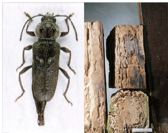
Figur 3.5: Husbock Hylotrupes bajulus och byggnadsvirke som angrips av husbock. Figurer från Ehnström och Axelsson [13]
