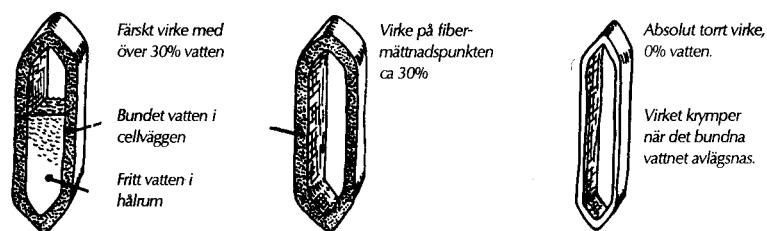
Figur 2.3: Fiber-mättnadspunkten och fördelningen av vatten i virke. Figur från Thomassen [39]
