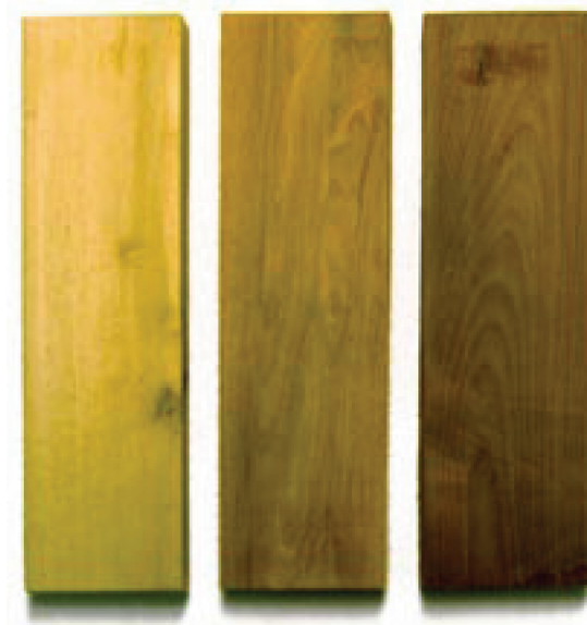
Figur 3.9: Färgförändring av björk behandlad med ThermoWood metoden, från vänster till höger: obehandlad, Thermo-S och Thermo-D. Figur från ThermoWood Brochure www.thermowood.fi
