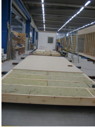
FIGUR 36. PREFABRICERING AV GOLV, TILL HÖGER SES FÖRBEREDELSE FÖR VIDARE INSTALLATIONER (STUDIEBESÖK "TRÅHUS" 2007)
