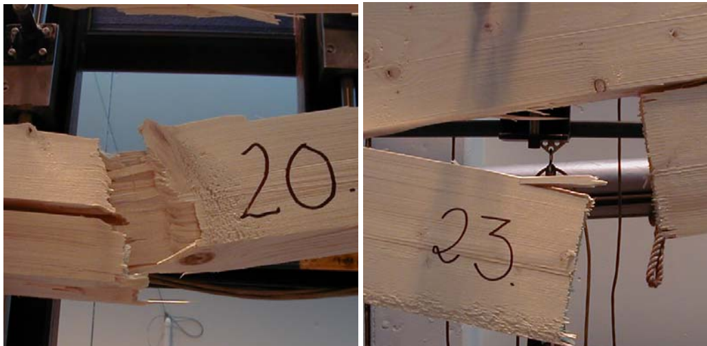
Figur 11: Balkbrott som startat i anslutning till en kvist respektive i en fingerskarv.
