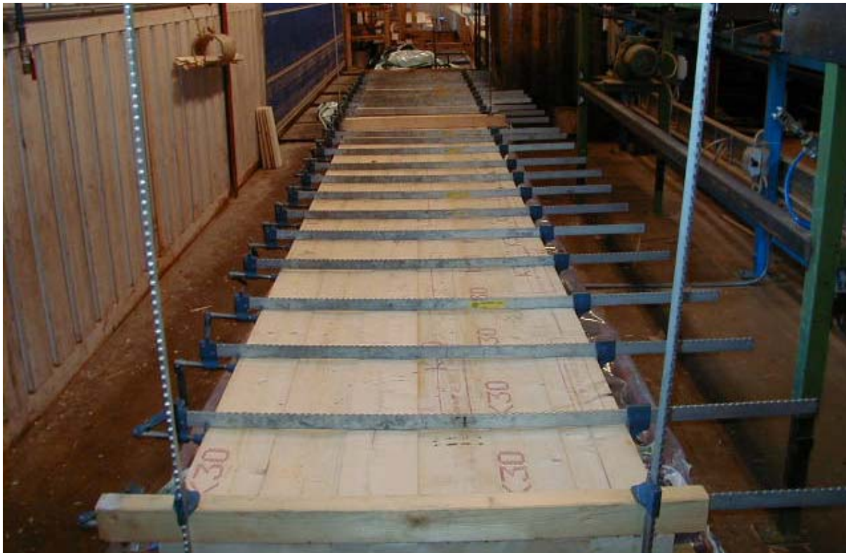
Figur 6: Limning av balkar för prov hos SP i Borås.
