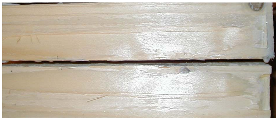
Figur 10: Uppspräckt limfog för kontroll av limningsresultat. Blixten blänker i limmet.
