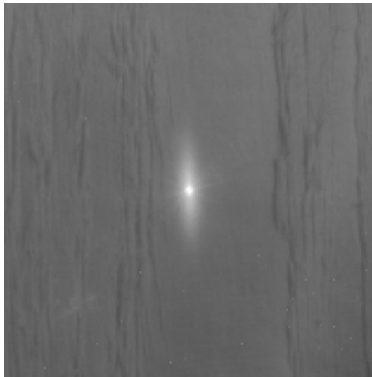
Figur 36 Laserpunkts utbredning i form av en ellips (Nyström, 2002)
