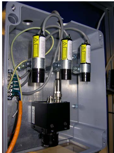
Figur 16. Delar av försöksutrustningen, kamera 1 och de tre laserpekare som är monterade ovanför.
