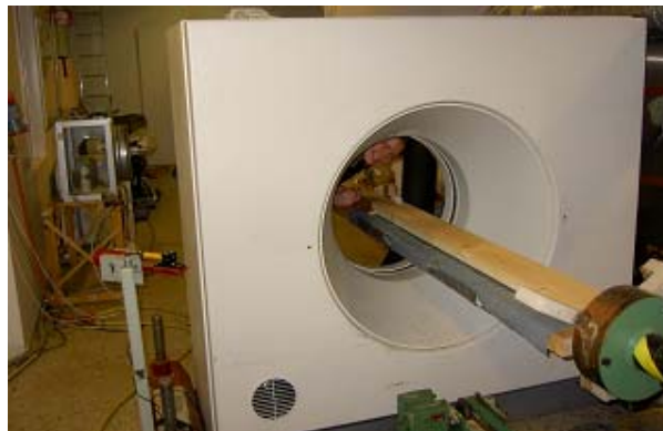
Figur 32. CT-scannern som testerna gjordes i på Luleå tekniska universitet i Skellefteå. Provbiten ligger på plats med splintsidan uppåt och snart ska skanningen göras. En laserstråle på brädan visar vart skanningen kommer att äga rum på provbiten så då är det lättare att placera provbiten rätt.
