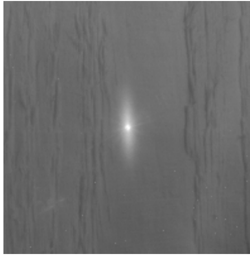
Figur 5. Trakeideffekten [11]. Träytan belyses med en punktlaser, ljuset sprids i träytan med större ljusspridning i fibrernas längsriktning jämfört med i fibrernas tvärsriktning.
