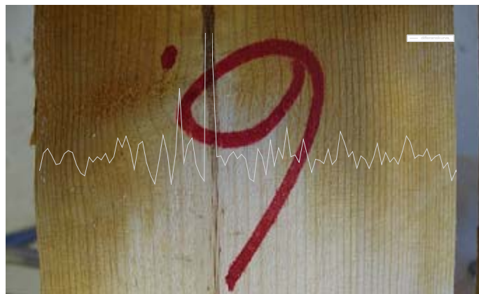
Figur 11. Visar provbit sex med fibervinkelkurvan inlagd efter filtrering. Märmen markeras tydligt i grafen med en hög topp som har ett värde som ligger på ett värde på ca 25 där den vanliga kurvan ligger mellan -1 till 1.
