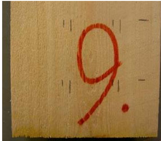
Figur 13. Provbit nio som är en furuplanka, de korta blyertsmarkeringarna visar centrum och de långa markeringarna visar splintens mitt område.
