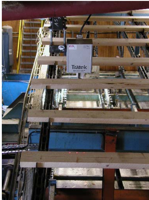
Figur 4. Fibervinkel- och kärnvedsmätare [1] i ett sågverk. De tre laserpunkterna kan ses i kanten på den närmaste plankan, samtidigt som kameran tar bilder. Det sitter två likadana mätenheter på virkets över- respektive undersida för att få med brädans båda sidor i mätningen.
