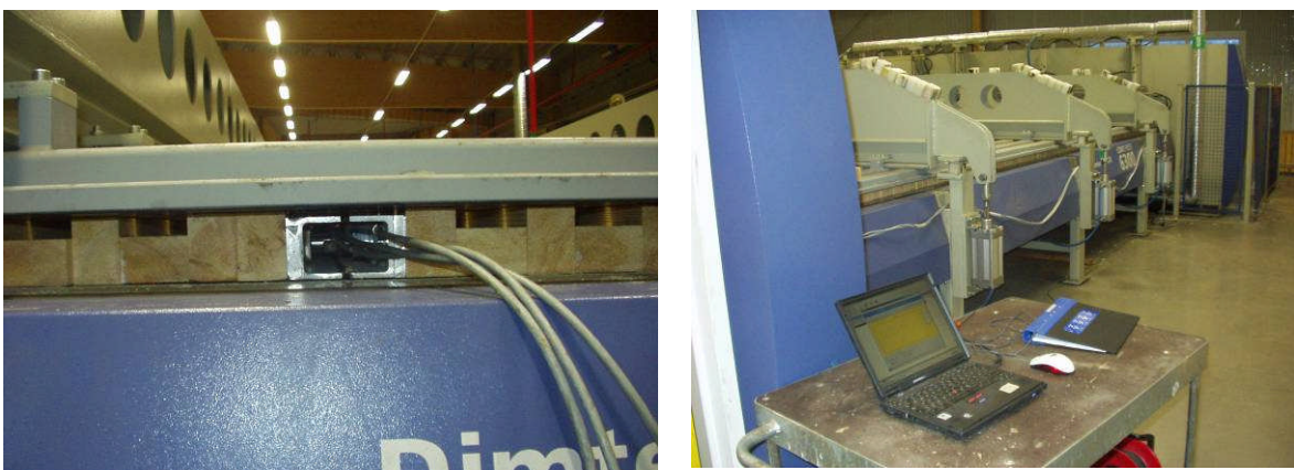
Bild 10: TV. Här kan man se änden av den yttre mätbalken. TH Allt kablage löper ut genom balkarna och matas successivt efter då balkarna rör sig genom pressen
