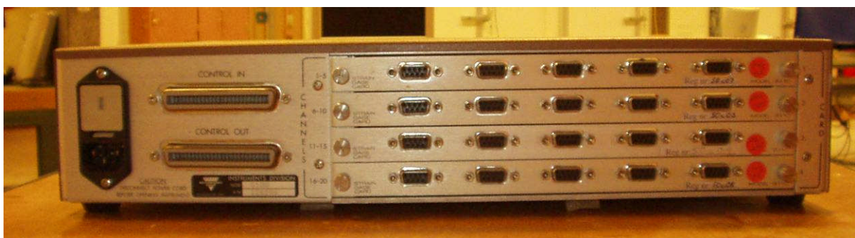
Bild 13: Baksida System 5000, Här med 4st strain kort för lastceller monterade med totalt 20 ingångar. Olika typer av givare kräver olika typer av kort.
