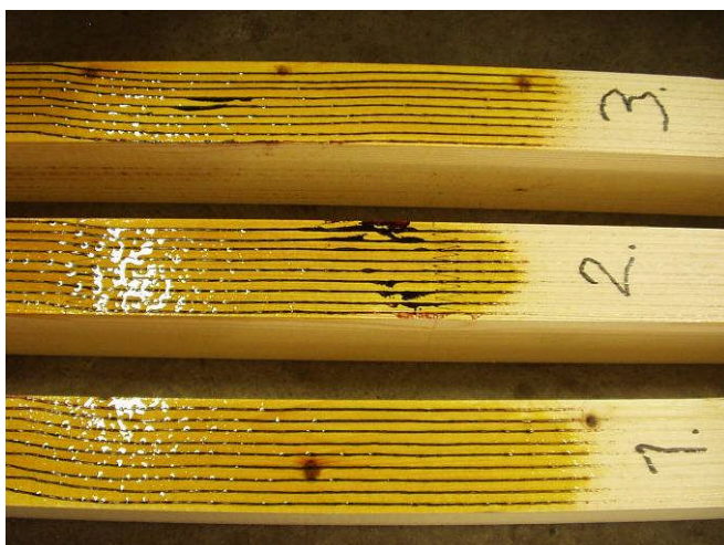
Bild 4: Man kan här tydligt se hur limsträngarna framträder då man behandlar med jod/vatten lösning
