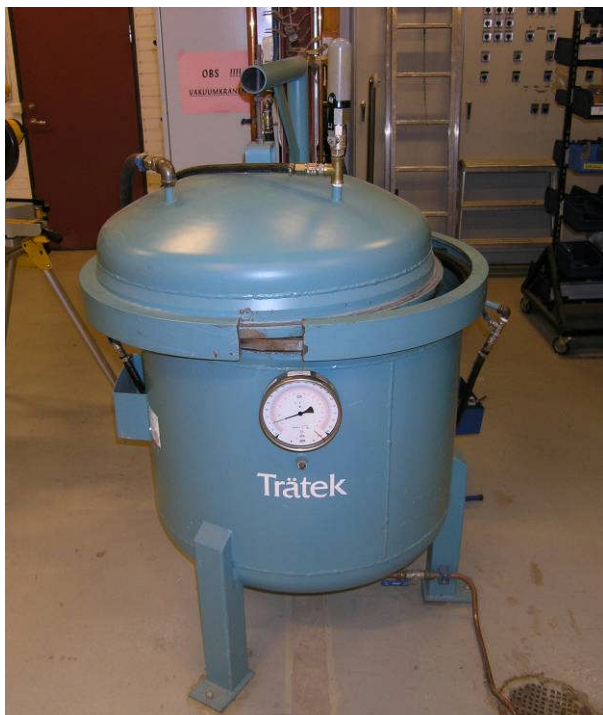
Bild 5: Tryckkärl som används för delamineringsprov.
