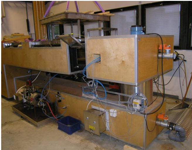
Bild 6: Labbtork med kontrollerat klimat för delamineringsprov.
