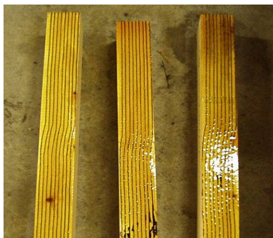
Bild 15: Limsträngar före och efter behandling av jod-/vattenlösning. Limsträngarna framträder som svarta streck på lamellerna. Det fanns vissa tendenser till ojämn limspridning med detta kunde härledas till de korta provbitarna.
