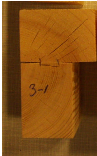
Bild 15: Man kan här tydligt se hur limfogen öppnat sig efter delamineringsprov.
