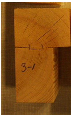
Bild 7: Provkropp efter delamineringsprov.
