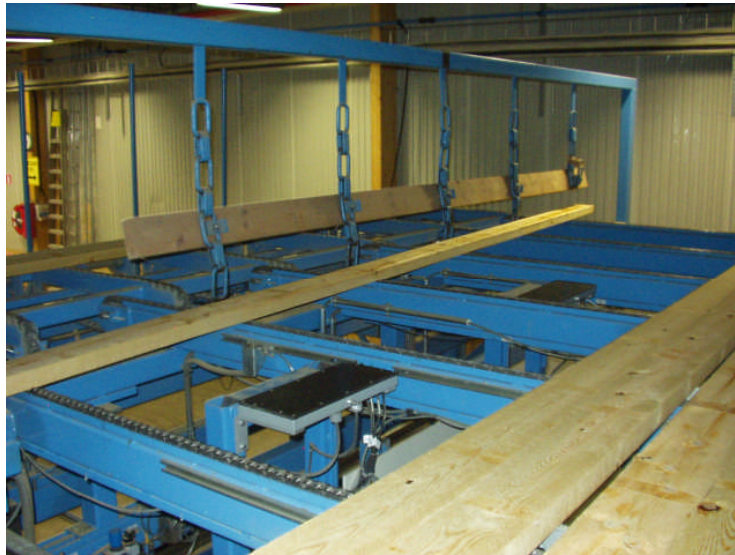
Bild 3: Apex on-linefuktkvots mätare. Råmaterialet passerar mätutrustningen på en tvärtransport.
