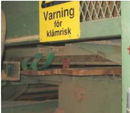
Bild 43. Visar en korrekt inställd "jämndragare".
