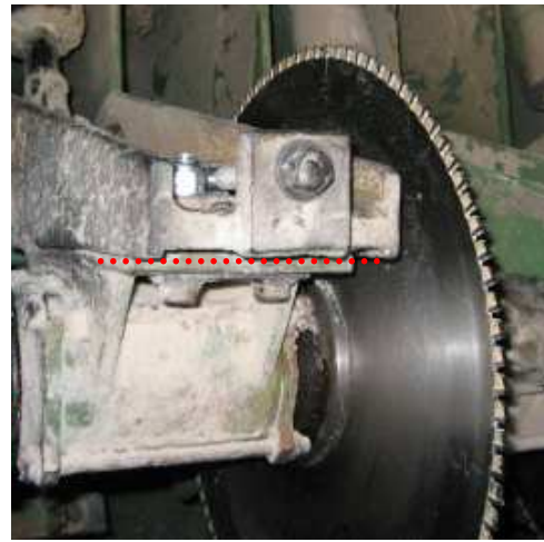
Bild 33 b. Ytorna där spindeln och armen möts är den streckade röda linje.
