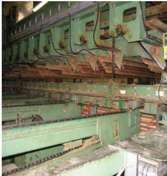
Bild 46. Visar strökassetterna där torkströn samlas innan de läggs på virkesskikten.
