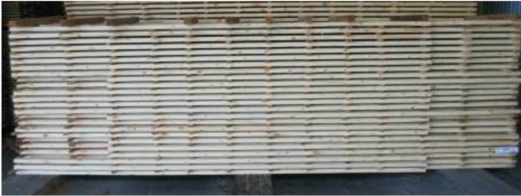
Bild 7. Visar ett färdigt torkpaket från ströläggaren.
