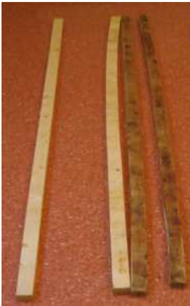
Bild 45. Visar ett referensströ (t.v.) och krokiga strön (t.h.).
