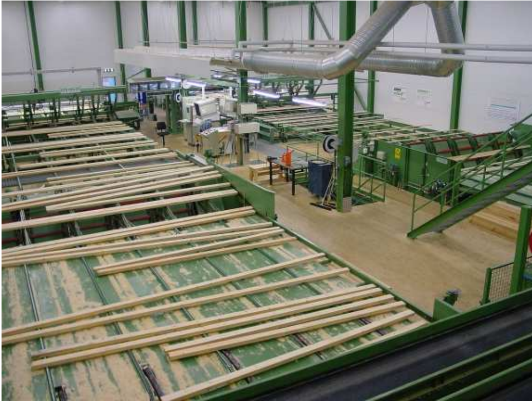
Bild 5. Visar råsorterings övervåning med planksidan till vänster och brädsidan till höger.
