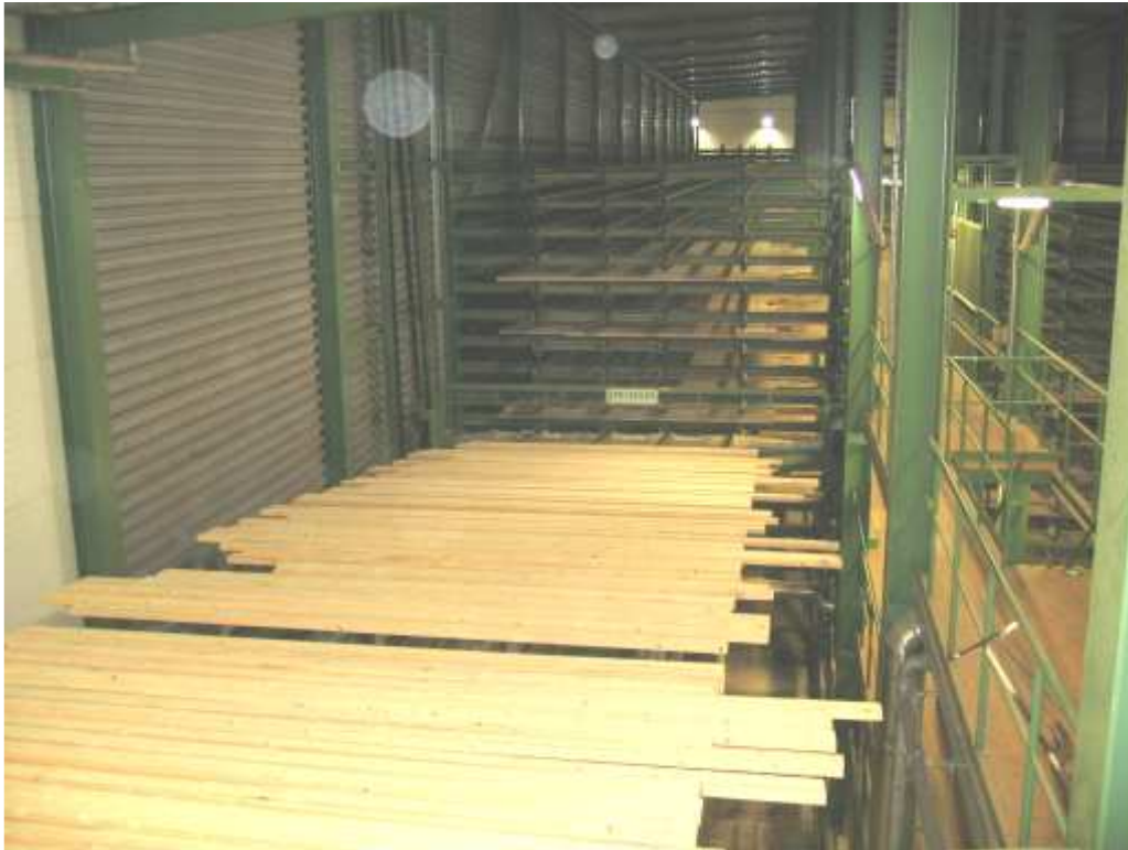
Bild 6. Visar traysortern. Här syns att virke ligger i ett lager i traysorterns fack. Senare lämnar virket fackdelen fört transport till ströläggaren.
