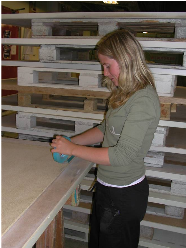
Tillverkning av dämplimskonstruktionen. Först tejpades kanterna för att undvika att limmet hamnar för långt ut på kanterna och leder till att limmet hamnar på sidan av spånskivan.
