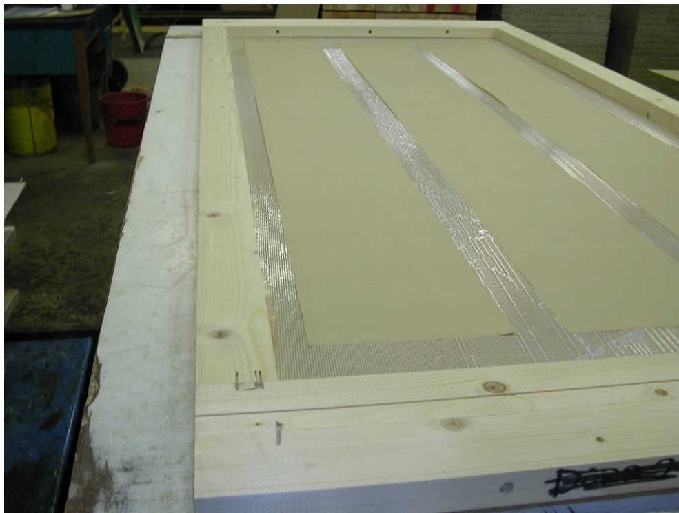
Tre pappers remsor lades på ytskivan innan fyllningen stoppades i. Detta för att minska styvheten i konstruktionerna.
