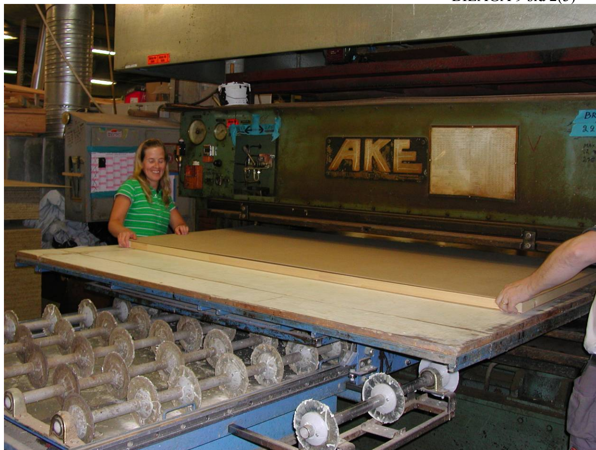
Dörrbladen pressades i en varmpress.
