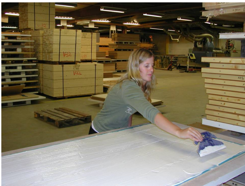
Dämplimmet spreds med limspridare (tandad spackel), till en tjocklek motsvarande 1kg/m 2 .
