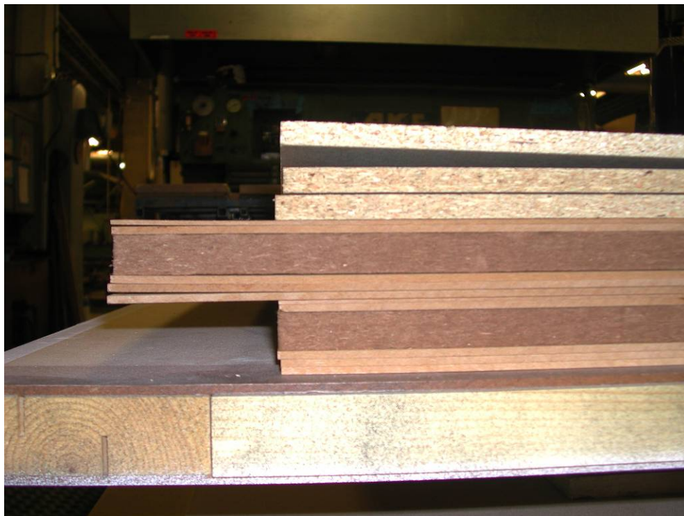
VD9 fyllningar. Överst spånskiva konstruktionen, mitten standard VD9- ramträ 60*60mm och längst ned standard VD9- ramträ 60*120 mm.
