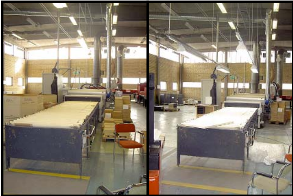
Figur 5.41: Den vänstra bilden är tagen med gamla belysningen och den högra bilden efter att den nya belysningen monterats
