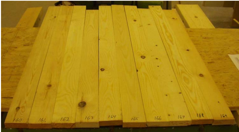
Figur 5.3: Exempel på råmaterialalets utseende och kvalitet till massivträväggar och provbitar.
