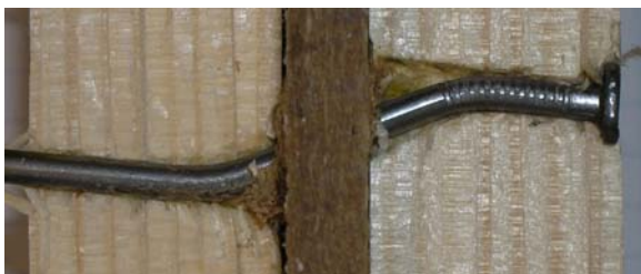
Figur 5.11: Exempel på spikarnas deformation (Mod 3) och boardens inverkan i provkropp nummer 202 överst, 161 i mitten och 140 nederst.
