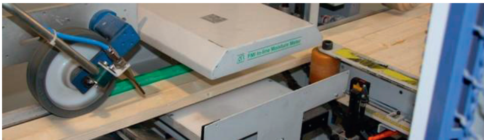
Figur 6. En modell av kapacitiv inlinefuktkvotsmätare (2).
