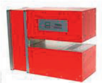
Figur 10. Inlinefuktkvotsmätare som använder mikrovågor (6).
