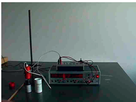
Figur 7. Laborationsuppställning av mätsystem för gammastrålning (3).
