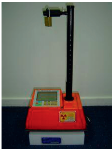
Figur 16. Exempel på utrustning för att mäta dämpningen av neutroner (11).
