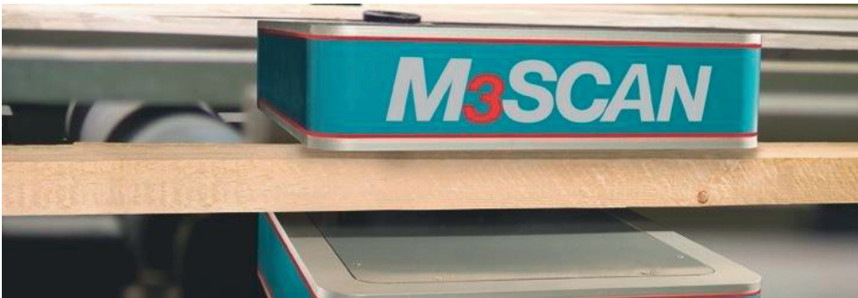
Figur 11. Exempel på en fuktkvotsmätare som använder sig av radiovågor (7).
