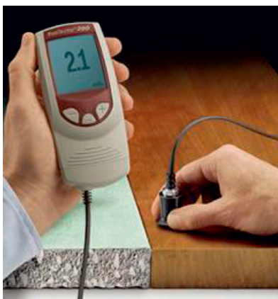
Figur 13. Figuren visar en variant av en ultraljudsmätare (9).
