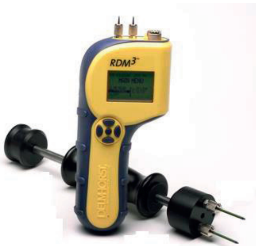
Figur 5. Exempel på handhållen resistiv fuktkvotmätare(1).
