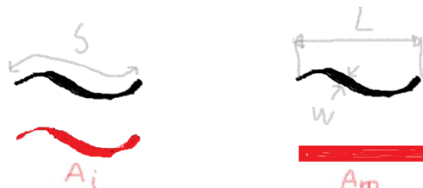
Figur 8. Med fotobaserad mätning mäts spricklängd som S och yta som A_i . Med manuell mätning mäts spricklängd som L och yta som w multiplicerat med L , alltså A_m . Från figuren ser man att (vanligtvis) S > L och A_m > A_i . Från examensarbete (Manninen, 2012)
