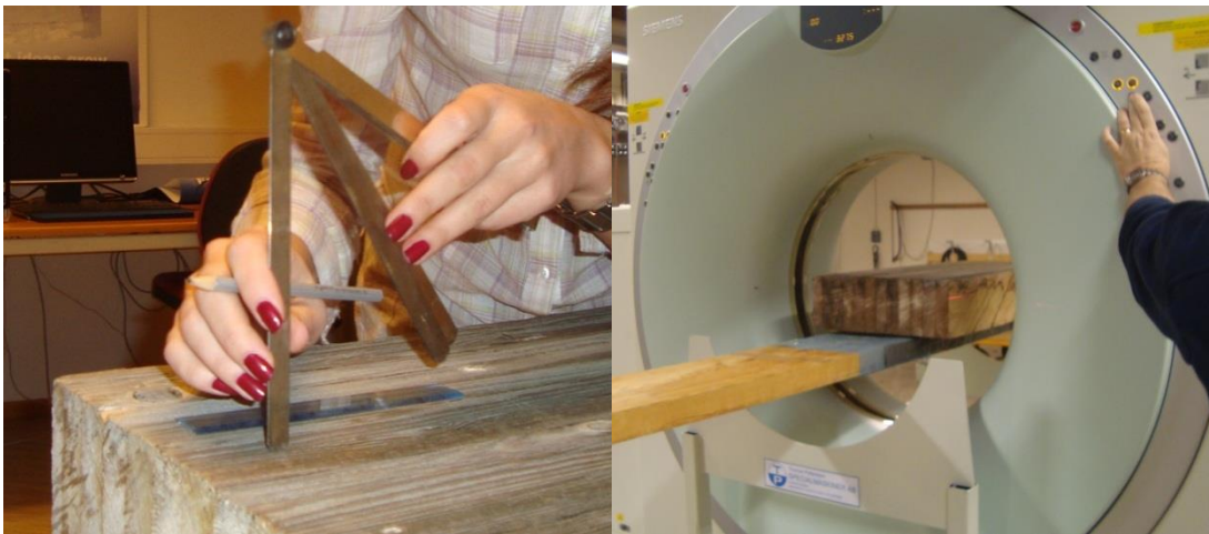
Figur 15. Bestämning av sprickans djup med två metoder a) Manuellmätmetod b) CT scanning och bildbehandling
