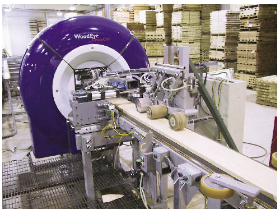
Figur 1. Scanner från WoodEye som kompletterats med en ultraljudssensor bestående av oljefyllda hjul för detektion av osynliga sprickor, installerad vid Baird Brothers sawmill (FDM Online, Juni 2006).
