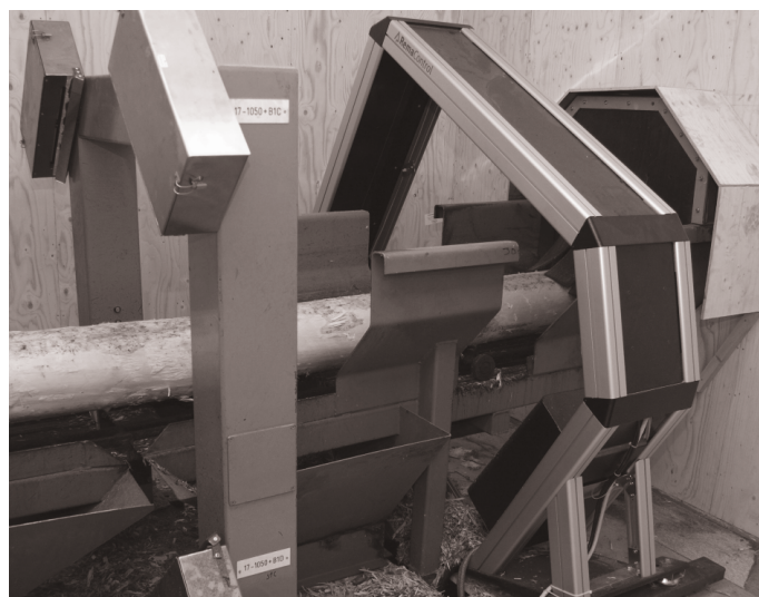
Figur 1: Testinstallationen i Munksund. Till vänster en optisk 3D-mätram från MPM Engineering och till höger en enriktnings röntgenmätram från RemaControl.
