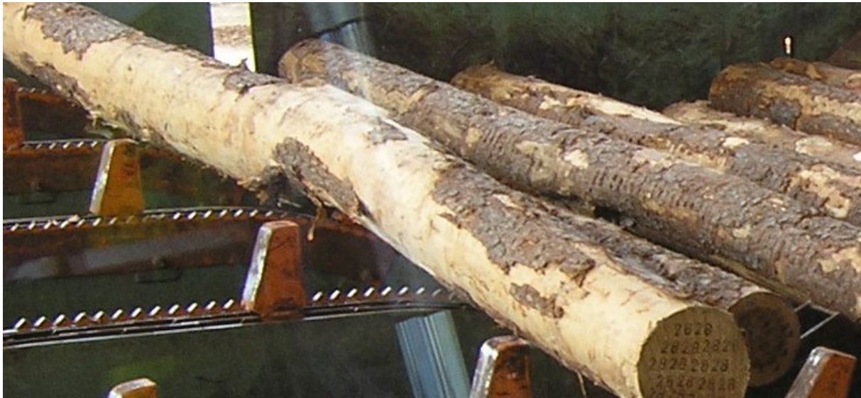
Figur 3. Exempel på stockar som valdes för att den yttre formen tyder på toppbrott.
