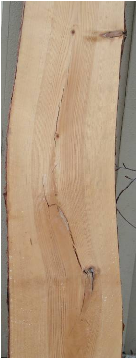
Figur 1. Foto av planka med toppbrott
