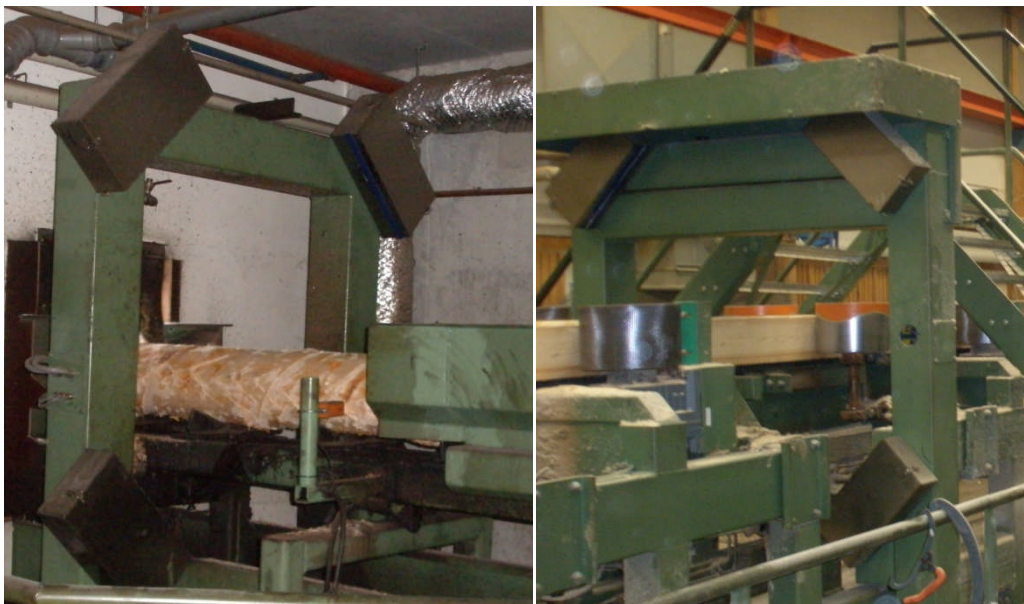
Figur 7: 3D mätram för rundtimmer (vänster) och 3D mätram efter fyrkants reducering (vänster)
