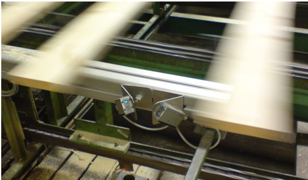
Figur 13: Färgkänsliga fotoceller som läser färg som skjutits på RFID plank
