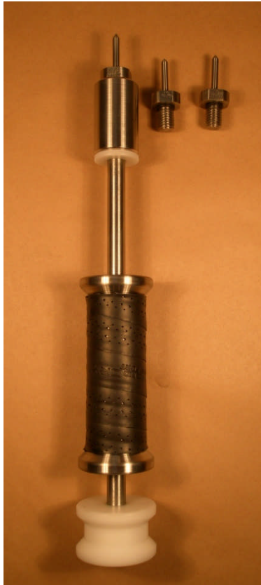
Figur 3: Glidhammare framtagen för applicering av RFID taggar
