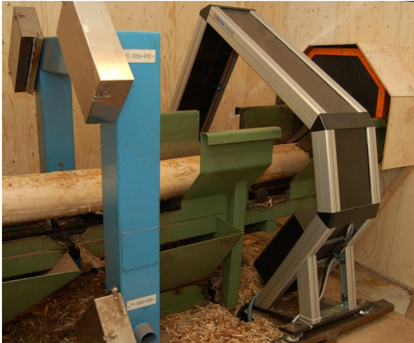
Figur 4: Röntgenram från Rema följt av 3D ram från MPM
