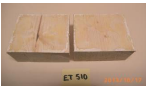
Epoxilimning efter delaminering
