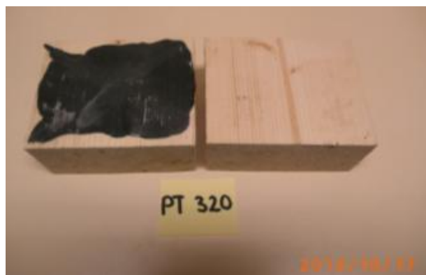
Polyuretanlimning efter delaminering
