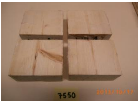
Polyuretanlimning efter delaminering
