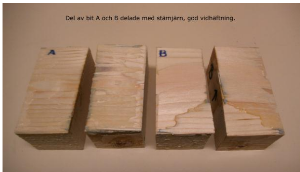
Del av bit A och B delade med stämjärn, god vidhäftning
