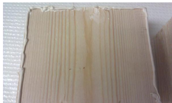
En liten ram i de fall limmet riskerar flyta ut ur fogen. Ytorna konvexa så kontakt mellan bitarna i mitten och spalt ute i kanterna till vänster och höger.
