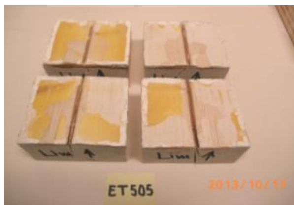
Epoxilimning efter delaminering
