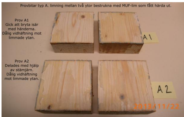
Provbitar typ A, limning mellan två ytor bestrukna med MUF-lim som fått härda ut, dålig vidhäftning mot limmade ytan
