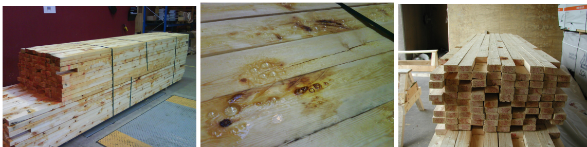
Figur 14. Hartsutträngning efter impregnering av furuvirke (vänster och mitt) och gran (höger).
