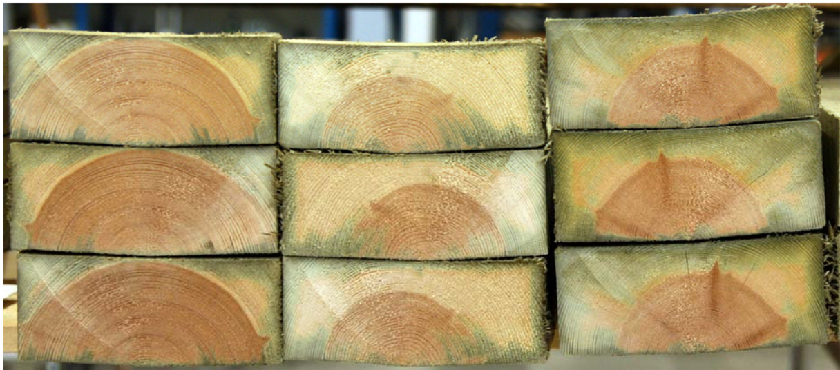
Figur 14 Missar vid impregnering av helt råa centrumplank uppvisar liknande utseende som impregneringsmissar av torra (ca 16 %) kärnvedsrika centrumplank
