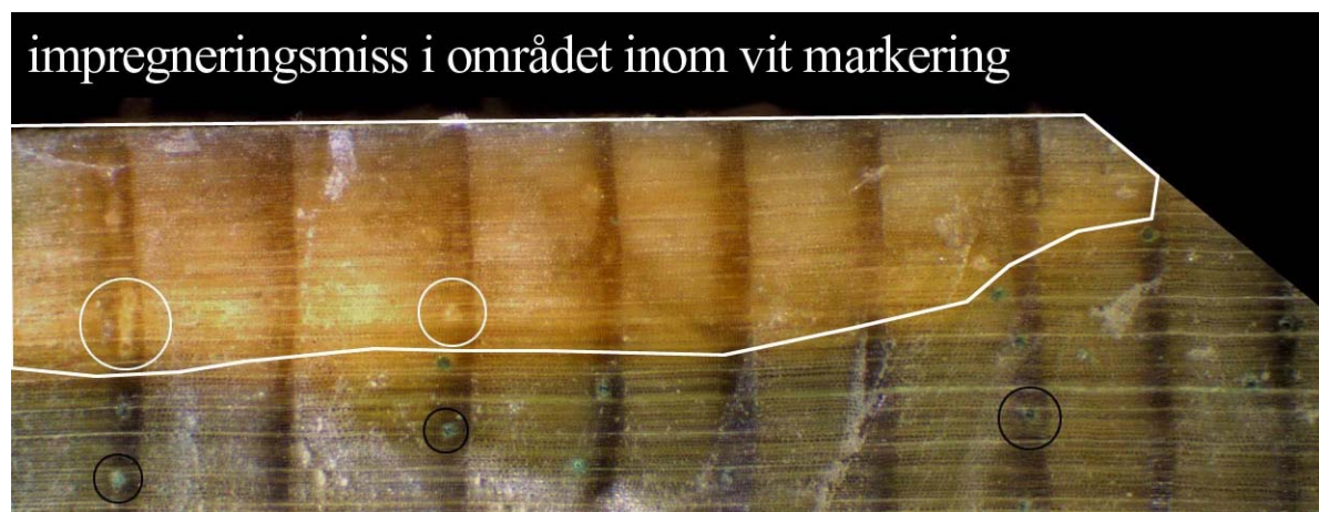
Figur 4 Vita ringar visar hartskanaler utan medel i det ljusa området med miss(vit markering). Svarta ringar i fullimpregnerat område visar hartskanaler där epitelcellerna är grönfärgade av impregneringsmedel.
