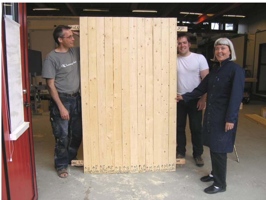
Figur 2 Sista provpanelen tillverkad. Vänstra halvan av varje panel visar splintsidor och höger halva märgsidor.
