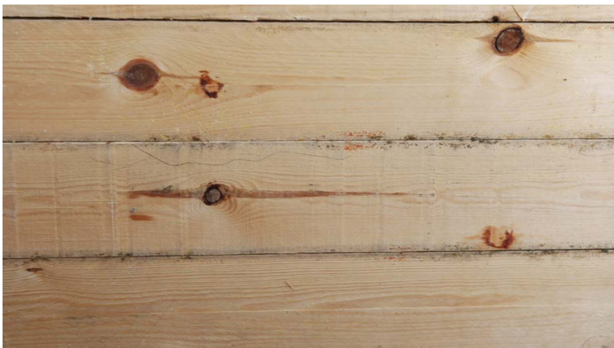
Figur 7 "Kanteffekt". Mögel som vuxit på anrikade kanter i spalten mellan bräderna har i några fall krupit över på flatsidorna av vissa bräder. Dessa kanter bearbetas (not/spont) i produktion av råspont varvid de anrikade zonerna avlägsnas. På försöksvirket har dock kanterna inte bearbetats, därav denna "kanteffekt".
