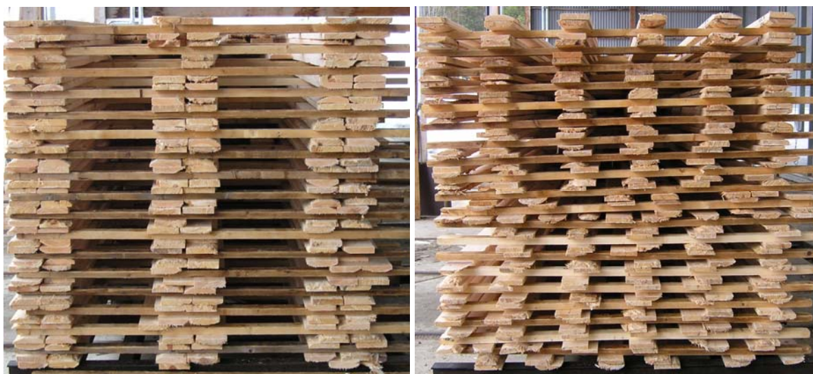
Figur 14 Parvist jämndragna brädpar (vänster) har betydligt stabilare anliggning mellan bräderna i ett dubbellagt par jämfört med enkeldragna brädpar (höger). Enkeldragna brädpar glider lättare i sidled vid trucktransport speciellt om virket är fruset. Observera att paketen inte är de försökspaket som ingår i denna studie utan paket från den normala produktionen.
