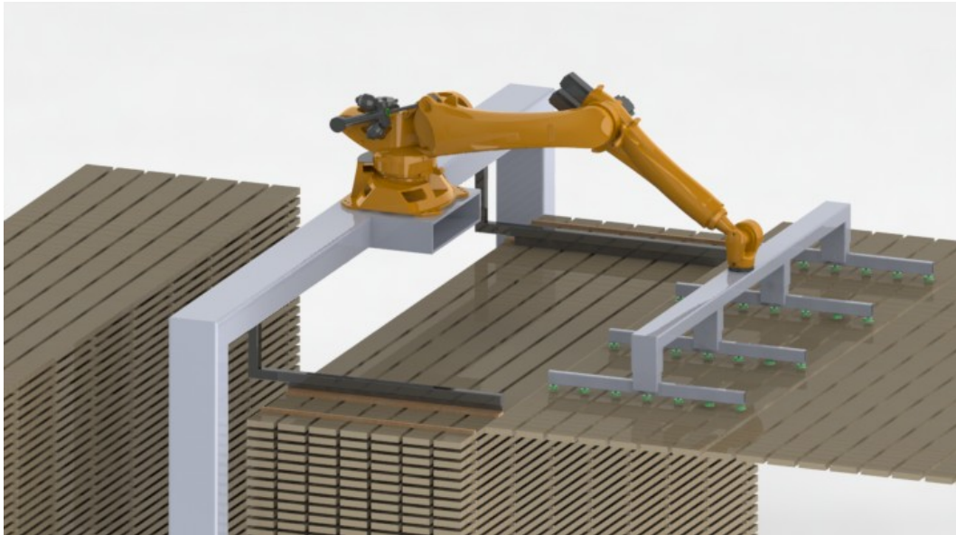
Figur 14: Exempel på robotanläggning för plockning av lager brädor eller plank.
