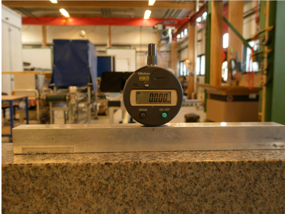
Figur 13. Verktyg för kupp-mätning kalibreras mot den släta ytan
