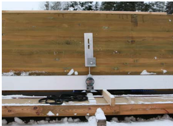
Nedböjningsmätning med mätklocka
