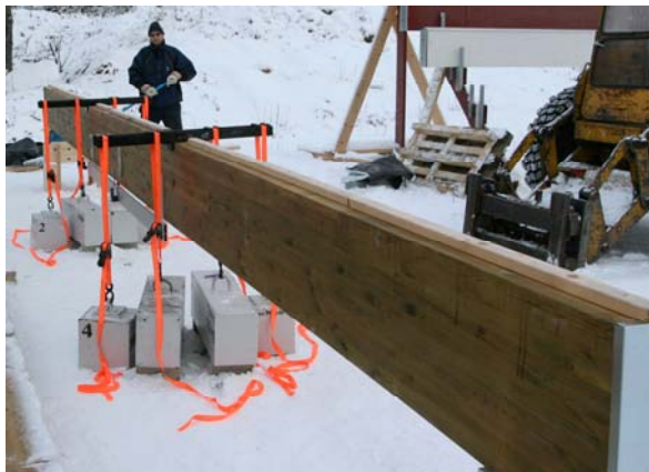
E-modulsmätning i fält.
