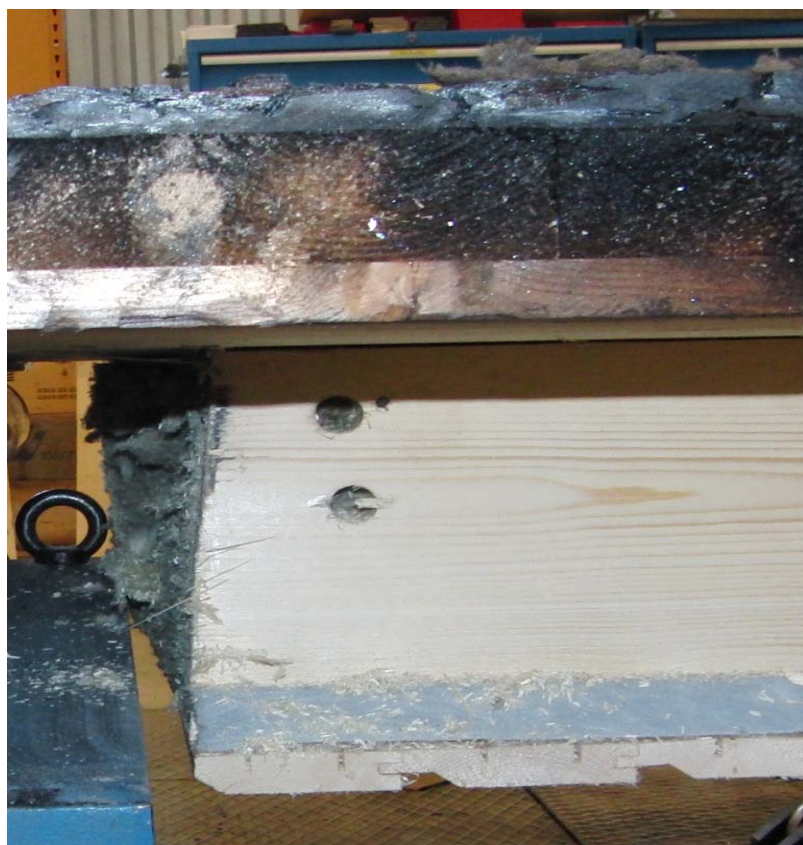
Figur 2 Sektion av vägg I efter brandprov
