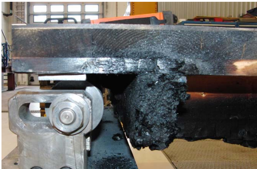
Figur 5 Återstående del av bjälklaget vid upplag efter brandprovning
