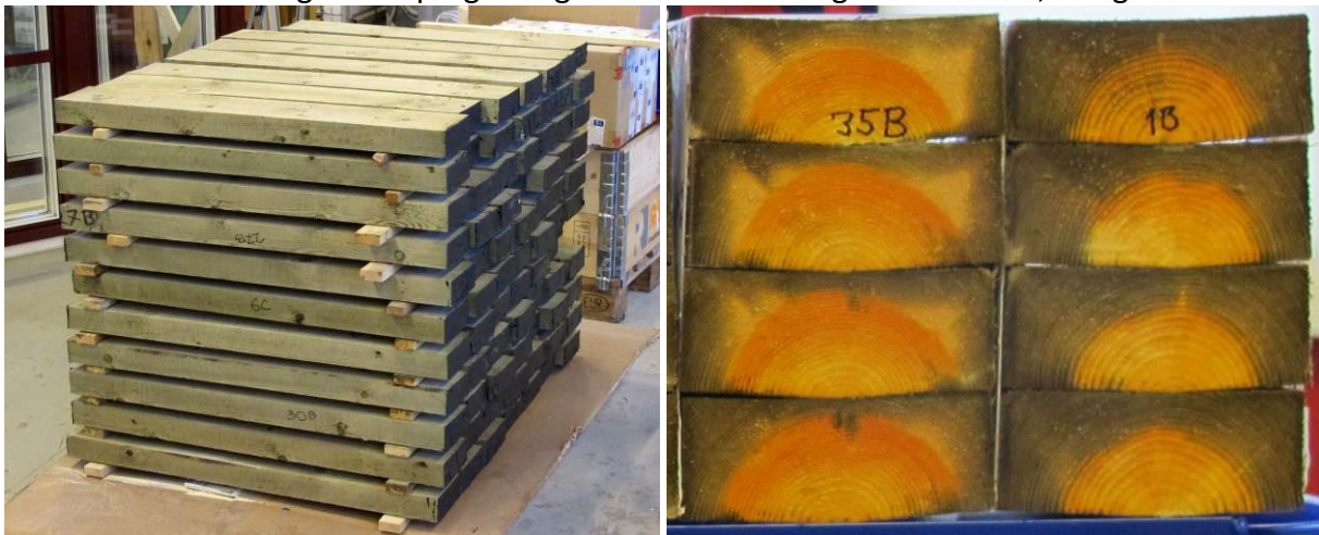
Figur 3 Vänster: Försöksmaterialet i väntan på uppkapning. Höger: Exempel på penslade kapsnitt med och utan impregneringsmissar.
